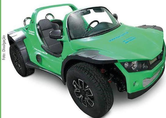
Em relação à manutenção, as peças mecânicas são as mesmas já utilizadas em buggys tradicionais. O powertrain – motor elétrico e inversor fornecidos pela WEG – praticamente não gera manutenção.
