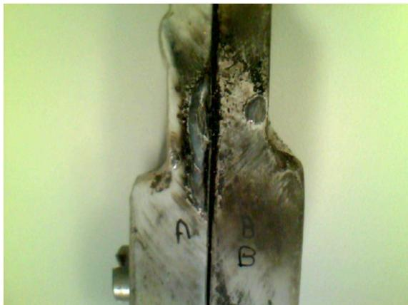
Figura 7 - Amostra 02: pedaço da luminária similar a Amostra 1 com duas marcas obtidas em laboratório: A-lado esquerdo e B-lado direito.
