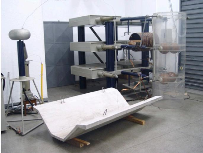
Figura 07: Montagem para ensaio de impulso de corrente.
