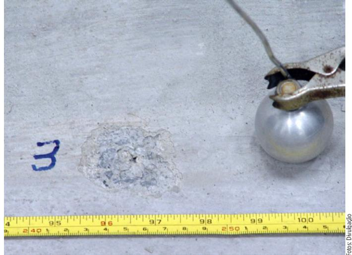
Figura 08: Ensaio de impulsos de corrente – detalhe do dano.
