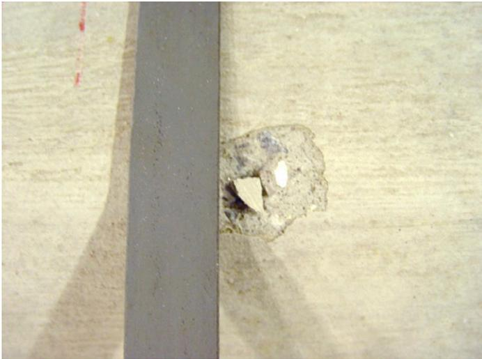
Figura 02: Detalhe do eletrodo e do dano para tensão prospectiva de 800 kV.
