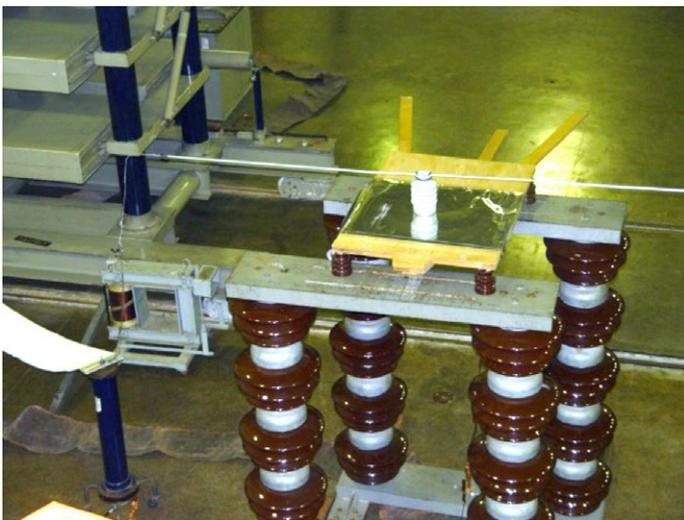
Figura 04: Ensaio realizado em isolador sobre chapa metálica
