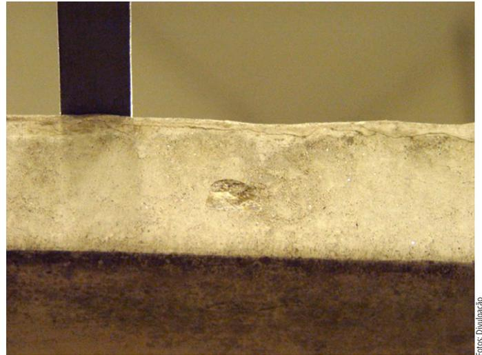
Figura 03: Detalhe do dano (na lateral) para tensão prospectiva de 60 kV.
