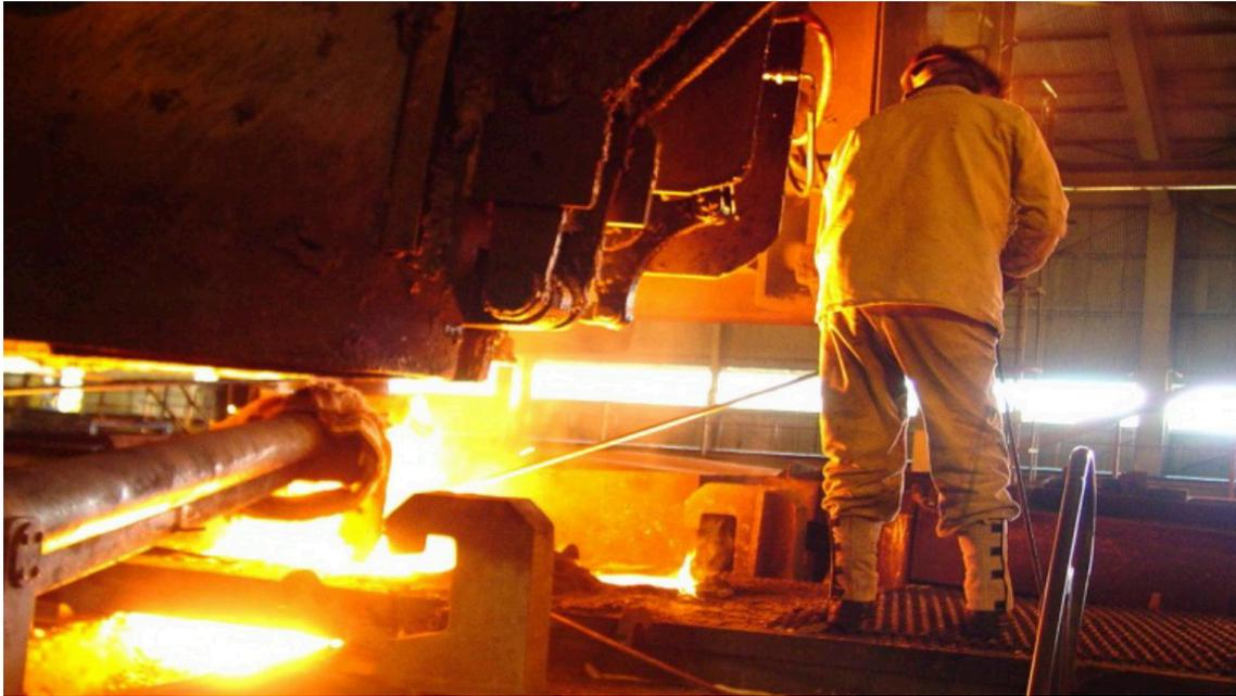
Figura 5 - Medição da temperatura do aço líquido no distribuidor com lança de medição manual.
