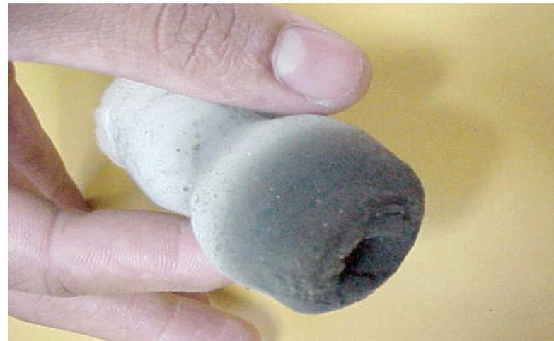
Figura 2 - Interferência gerada no interior do tubo de medição durante a operação - Sílica
