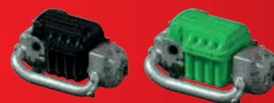
Os compressores Turbocor TTH e TGH, otimizados para aplicações de diferencial de pressão mais elevado, entregam a mais alta eficiência do mercado sem redução de performance nem desgaste mecânico, pois não requerem óleo nem contato em sua operação. Eles chegam a 40% de melhora na eficiência em cargas parciais se comparados a compressores tipo parafuso e apresentam um retorno de investimento inferior a três anos, com performance sustentável durante toda a sua vida útil.
