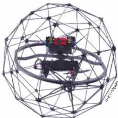
sificadas contendo gases inflamáveis ou poeiras combustíveis. Neste caso os drones a serem utilizados nas inspeções das plataformas de petróleo devem possuir certificação de conformidade para tipos de proteção “Ex” de acordo com as Normas Técnicas Brasileiras adotadas da Série ABNT NBR IEC 60079 (tais como Ex “e” – Segurança aumentada, Ex “i” – Segurança intrínseca), de acordo com o requerido na atual Portaria Inmetro 0179/2010. <http://www.inmetro.gov.br/legislacao/rtac/pdf/RTAC001559.pdf>
