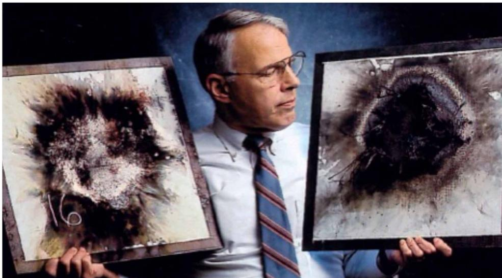
Figura 3: Marcas deixadas por descargas atmosféricas em fuselagem de aeronaves
