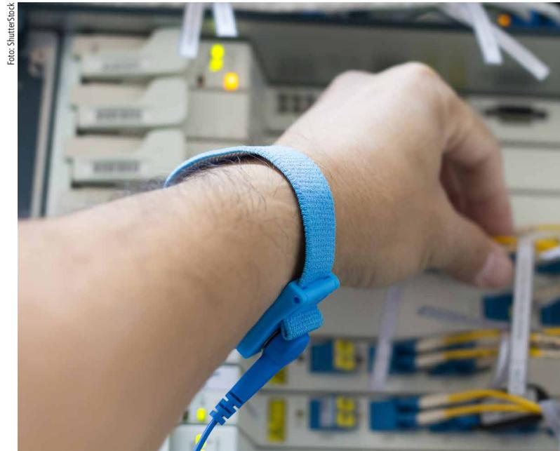
com calcanhares ou calçado ESD e roupas de proteção contra ESD, ou pelo Aterramento secundário, através de piso com superfície dissipativa e calçado ESD, roupas de proteção contra ESD, correias de pulso e mantas de bancada conectadas a um Ponto de Terra adequado.
