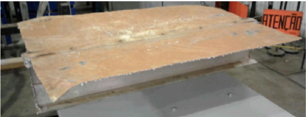
Figura 2: Detalhe da chapa para testes com correntes para verificar emendas
