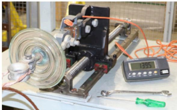
Figura 2 – Sistema de medição da carga mecânica (tração)
