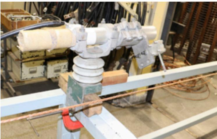
O eletrodo utilizado é de aço 1020 e foi instalado conforme a Figura 9, onde o “gap” entre o eletrodo e a amostra foi ajustado em 60 mm, ficando a uma inclinação aproximada de 45° em relação ao plano da amostra (paralelo ao plano da bancada de ensaio). Foram feitos três ensaios em cada tipo de amostra, sendo uma aplicação em cada amostra.
