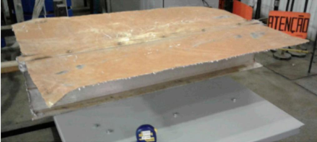
Foto 05: Amostra com emenda de Domo para ensaios
