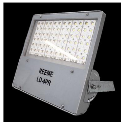
tecnologia LED SMD (Light Emitting Diode) de alto desempenho, possuindo vida útil de até 90.000 horas. É fornecido com driver dimerizável e proteção contra surtos; acabamento em pintura eletrostática em poliéster resistente a UV e intempéries; nas potências de 100 à 600W com eficácia de até 160 lm/W.
