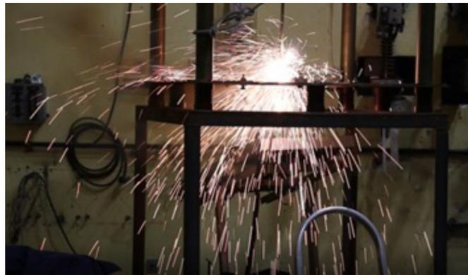
Figura 8: Arco no Gap entre a fonte e a ponta da haste durante o ensaio
