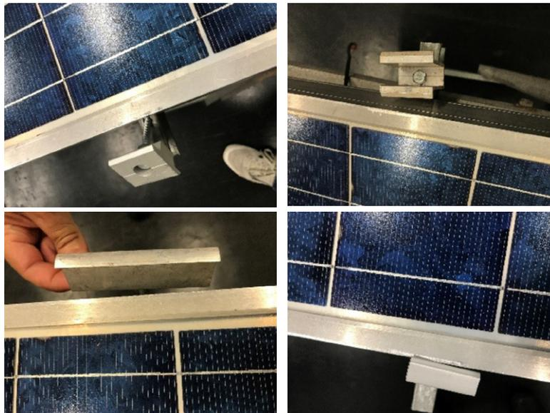
Figura 17 a), b), c) e d): Conectores após os ensaios com corrente.
