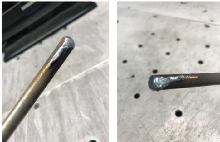
Figura 18: Pontas dos mini captadores após os ensaios
