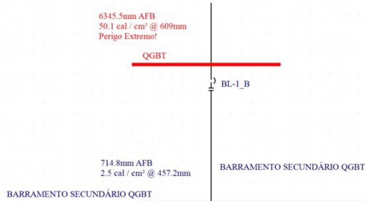
Figura 18 - Valores de energia incidente – QGBT
