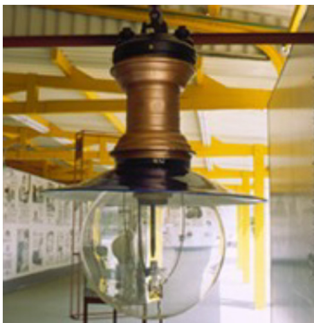
Figura 5. Lâmpada a arco voltaico, tipo arco fechado utilizada em São Paulo entre 1905 e 1920 - Museu da Energia [3].
