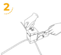
Colocar o iniciador eletrónico APLIWELD®-E sobre a tampa e ligar as pinças.
