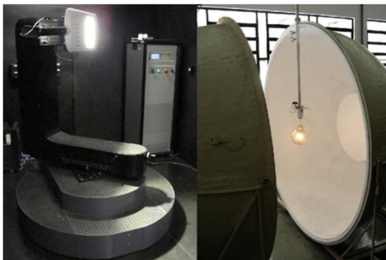
Figura 5. À esquerda, Goniofotômetro e, à direita, esfera integradora de Ulbricht's.
