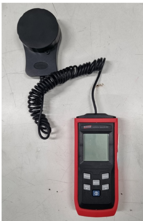
Figura 3. Exemplo de um luxímetro portátil, que possui o filtro V(l).
